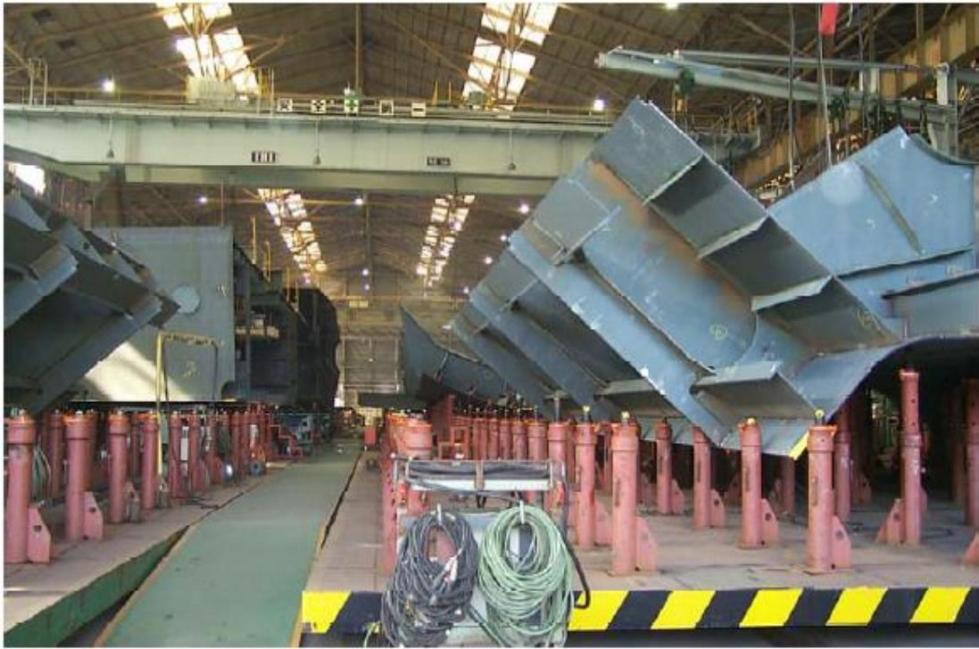
写真 10 IHI タクト時間に合わせて移動する曲面ブロック
