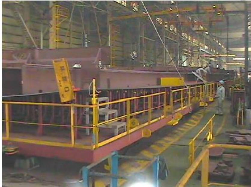
写真4 曲面ブロックのコンベアライン
