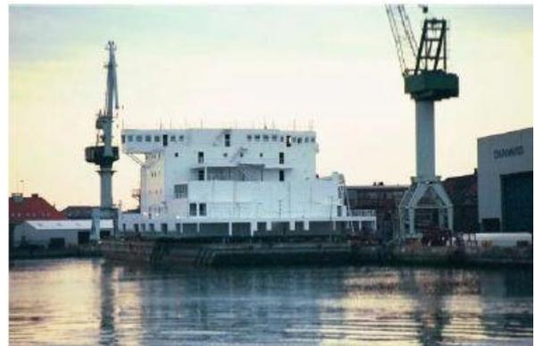
写真 31 下請けに出された船橋部の納品
