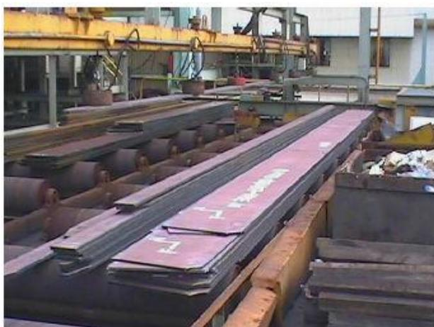
写真 21 加工順序通りに積み重ねられた資材
