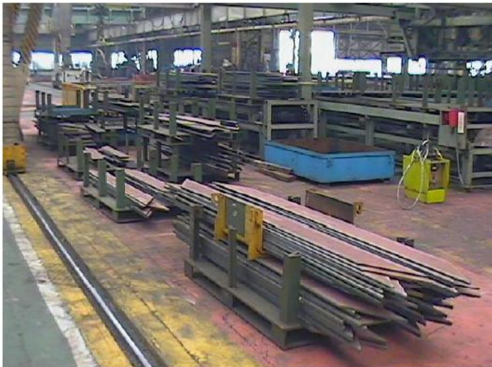
写真3 小組工場向けにパレットへ仕分けされたフラットバー
