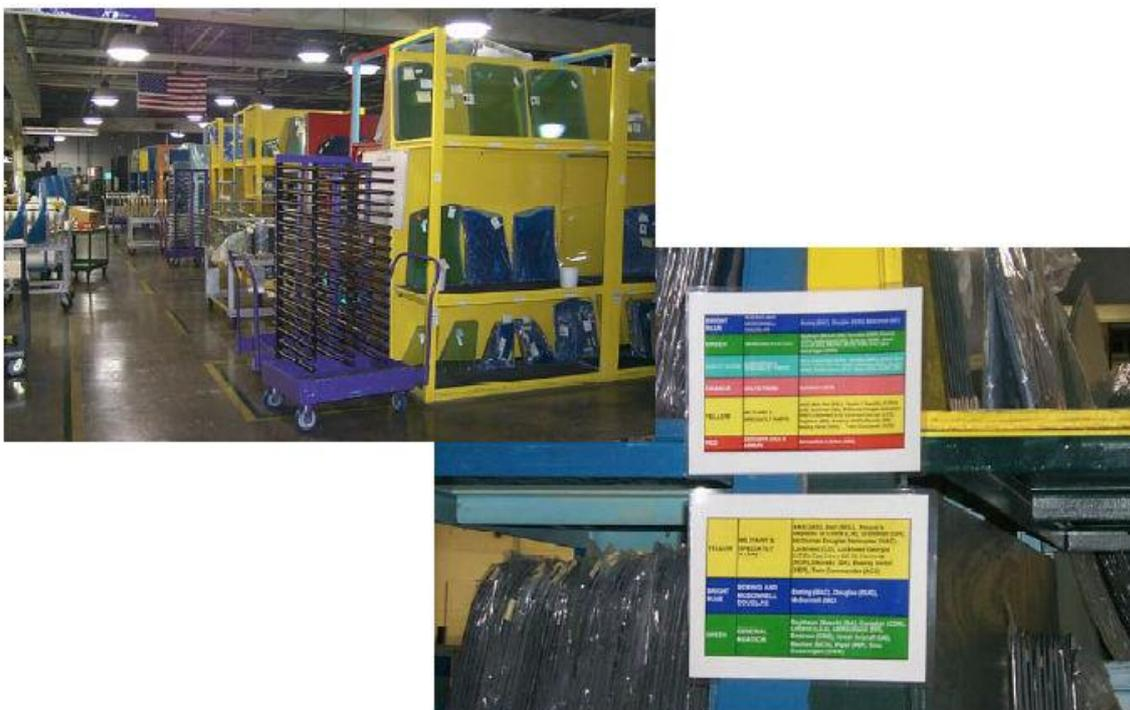
写真 12 PPG Huntsville（航空機部品メーカー）の中間製品のマーケットプレース
